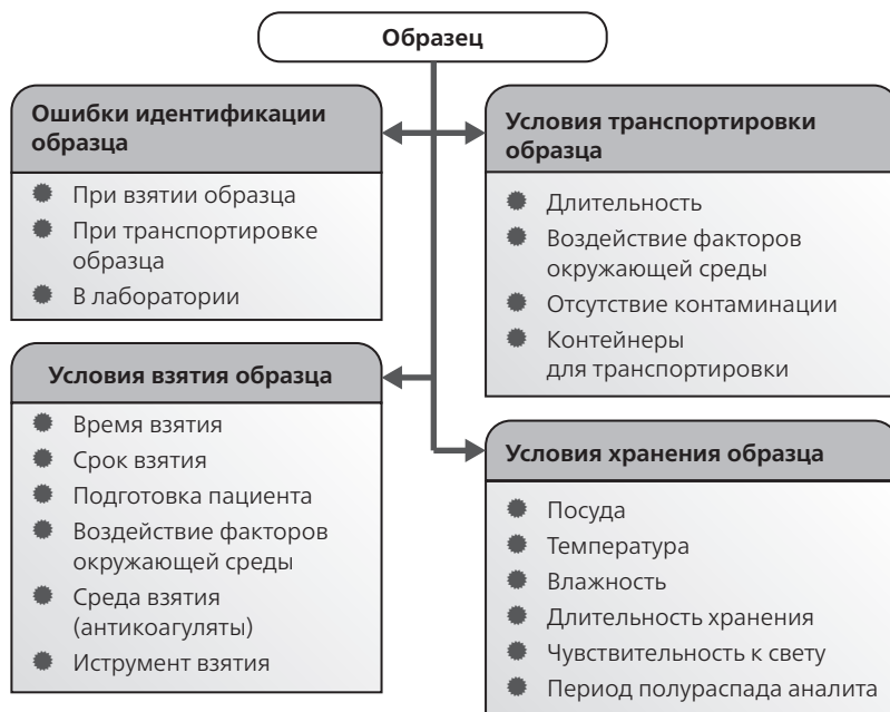
Рис. 4. Схема основных факторов преаналитического этапа клиничко-лабораторных исследований, влияющих на анализ образца
