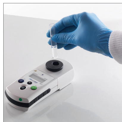
2 Приготовьте суспензию микроорганизмов и проверьте ее плотность по МакФарланду с помощью денситометра DensiCHEK® Plus
